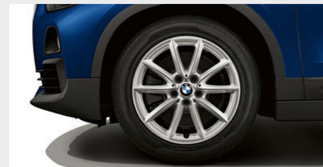
■ 17" легкосплавные диски V-spoke 560 Reflex Silver. Диски 7,5J x 17 с шинами 225/55 R17.
