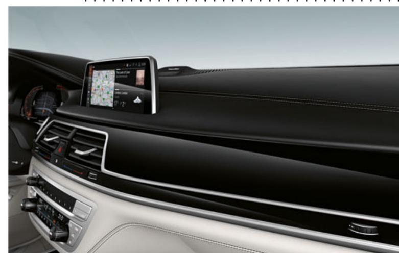
Декоративные планки BMW Individual "Черный рояльный лак" отражают исключительный характер материалов BMW Individual и свидетельствуют о тщательности обработки: шпон тольпанового дерева покрывается несколькими слоями лака и затем полируется до тех пор, пока не будет достигнута характерная глубина глянцевое покрытие.
